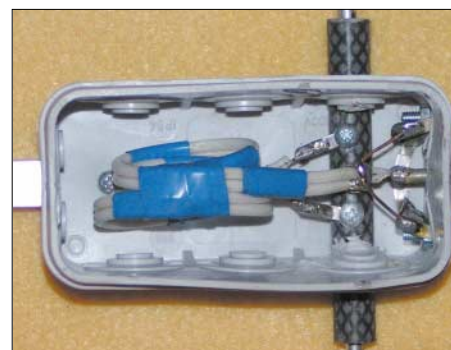
Bild 14: Eine andere Variante der Anpassdose mit RG-188U-Teflon-Kabeln
