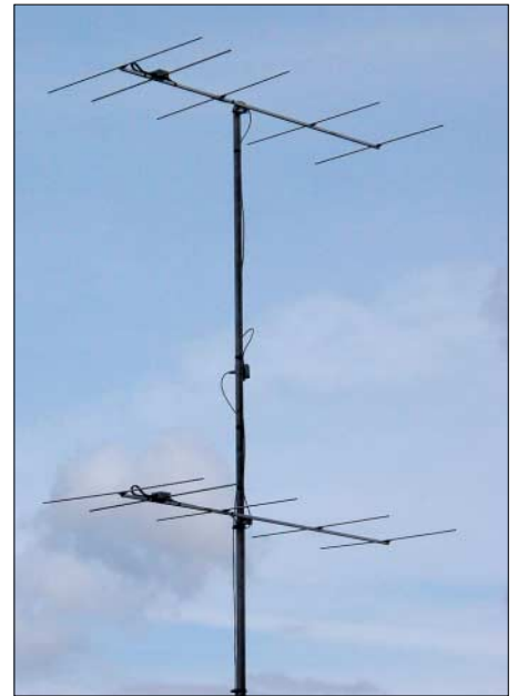
Bild 17: Die gestockte Gruppe 2 x 5-Element Fotos: DK7ZB
