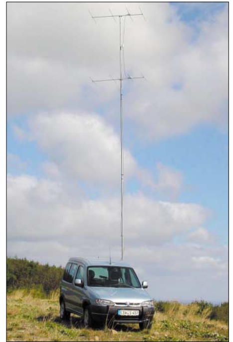
Bild 3: Die leichten 4-Element-Yagis lassen sich für Portabelbetrieb problemlos stocken.
